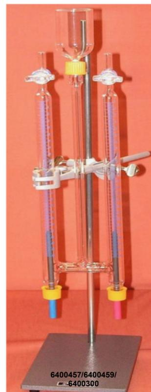
**Wasserzersetzungsgasapparate und Zubehör**
